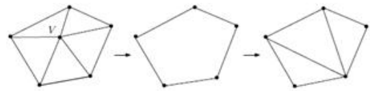
شکل ۴: مرحله‌ای از یک الگوریتم کاهش با استفاده از حذف نقطه.
